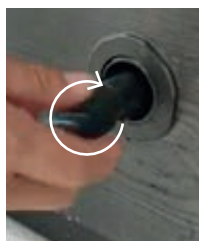
6. Pro zastavení vypouštění, otočte víčkem ve směru hodinových ručiček
